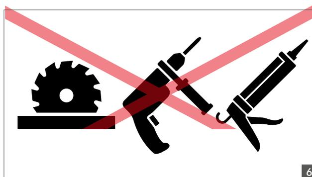
6 Kein Schneiden und kein Bohren der Profile, kein Verkleben!
